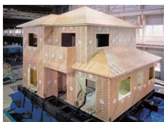
筑波研究所での三次元振動実験
